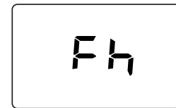
fig. 7- Purga de aire con ventilador apagado
